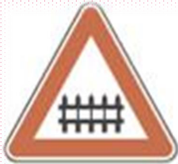
A 25 Železničné priecestie so závorami
